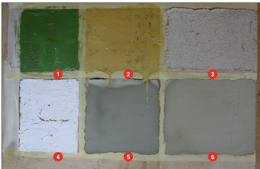
6 Agen (47) - Palais de Justice - Vue synoptique des essais de nettoyage pratiqués. Cliché du haut : à l'application Cliché du bas : après 48h de séchage.
